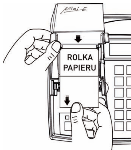
Rys. 2-4 Wkładanie rolki papieru
