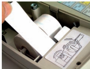
Rys. 2-9a. Zakładanie kopii do zwijacza
