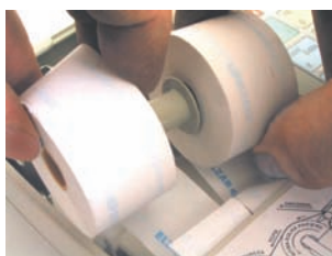
Rys. 2-7. Zakładanie papieru na rolkę rozwijacza
