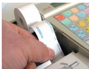
Rys. 2-5. Zakładanie rolki oryginału
