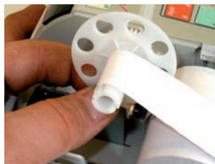
Rys. 2-9c. Zakładanie kopii do zwijacza
