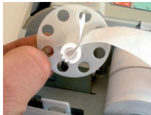
Rys. 2-9b. Zakładanie kopii do zwijacza
