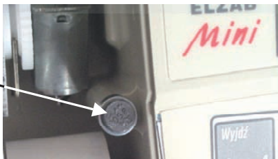
Rys. 2-13. Umieszczenie plomby serwisowej w kasie
