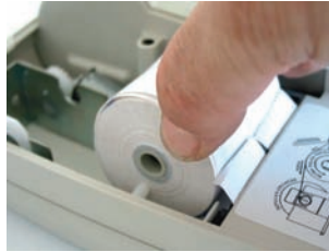
Rys. 2-8a. Zakładanie nowych rolek do rozwijacza
