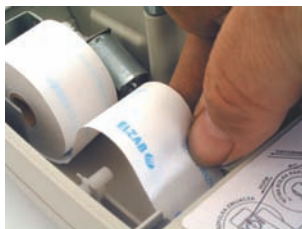
Rys. 2-4. Zakładanie rolki kopii
