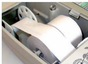
Rys. 2-9d. Zakładanie kopii do zwijacza
