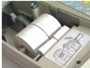
Rys. 2-8b. Zakładanie nowych rolek do rozwijacza
