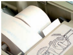
Rys. 2-10. Przygotowanie papieru do zamknięcia osłony drukarki
